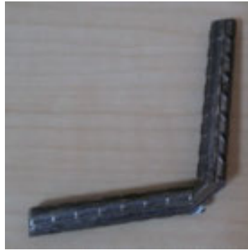
Şekil 2.1: 45^\circ açı ile kesilmiş kaynak numunesi
