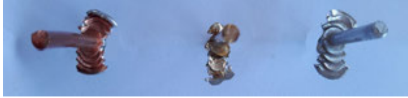
Şekil 2. a) birleştirilen tellerin önden görünüşü b) birleştirmelerin üstten görünüşü
