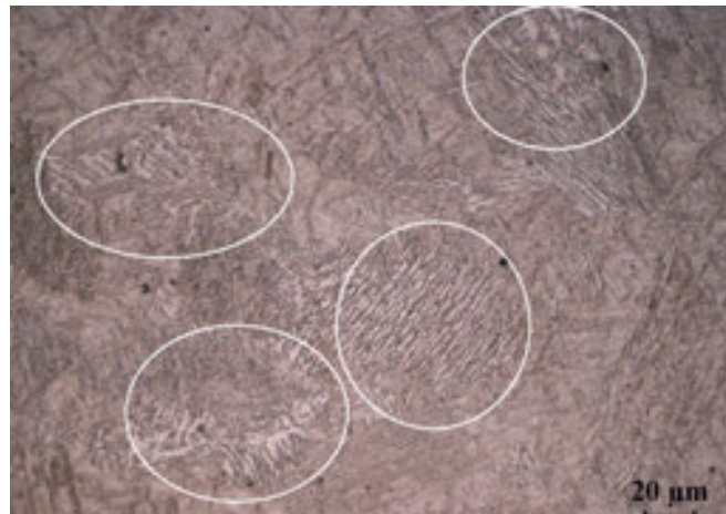
Şekil 5. Kaynak metalinde ergime bandına yakın olan bölgede meydana gelen levhalı (Widmanstättenferrit) oluşumlar
