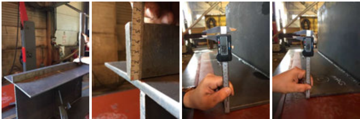
Şekil 3. T profillerin kaynatılması işlemi sonrası çarpılma ölçümleri.
