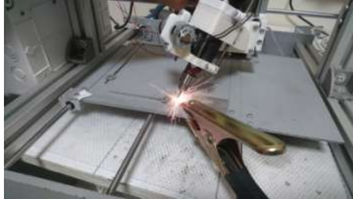
Şekil 3. ESD İlk temas görüntüleri ESD parametreleri: 450Hz, 100V.
