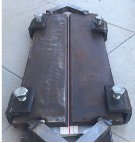
Şekil 1. Kaynak ağızı açılmış parçaların kaynak öncesi fikstürle sabitlenmesi.
